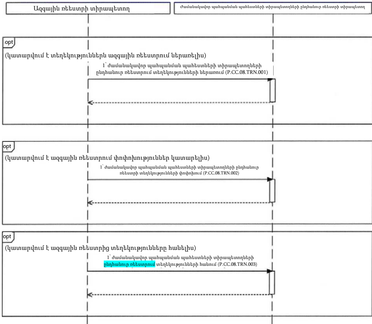
Նկ. 2 Ընդհանուր գործընթացի տրանզակցիաների կատարման սխեման՝ Ժամանակավոր պահպանման պահեստների տիրապետողների ընդհանուր ռեեստրը ձևավորելիս եւ վարելիս
